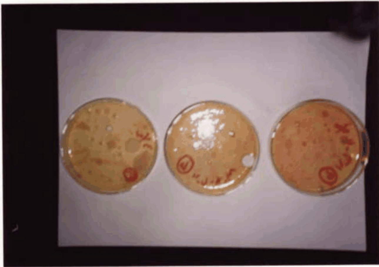
図-5。 Bacillus cereus (毒素性セレウス菌) SMU 1980 株のソレイユ産生オゾン 処理水 処理前 (左)、30秒処理後の培養結果 (中央) 及び60秒処理 (右) 注: オゾン水処理30秒及び60秒処理後でも生存コロニーが認められる。 (本菌は芽胞形成細菌で、消毒薬や物理的処理での抵抗性細菌である)
